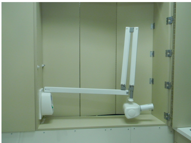
Малюнок 162. Настінний стоматологічний рентгенівський генератор в стоматологічній операції. Генератор прикріплений до довгого плеча, щоб легко дістати пацієнта до стоматологічного столу.
