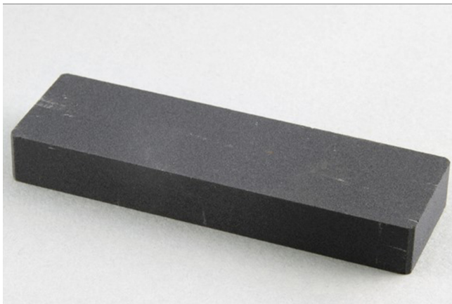
Малюнок 169. Плоский точильний камінь, необхідний для регулярного (в ідеалі після кожного використання) заточування всіх ручних інструментів. Потрібні також циліндричні та конічні заточувальні камені.
